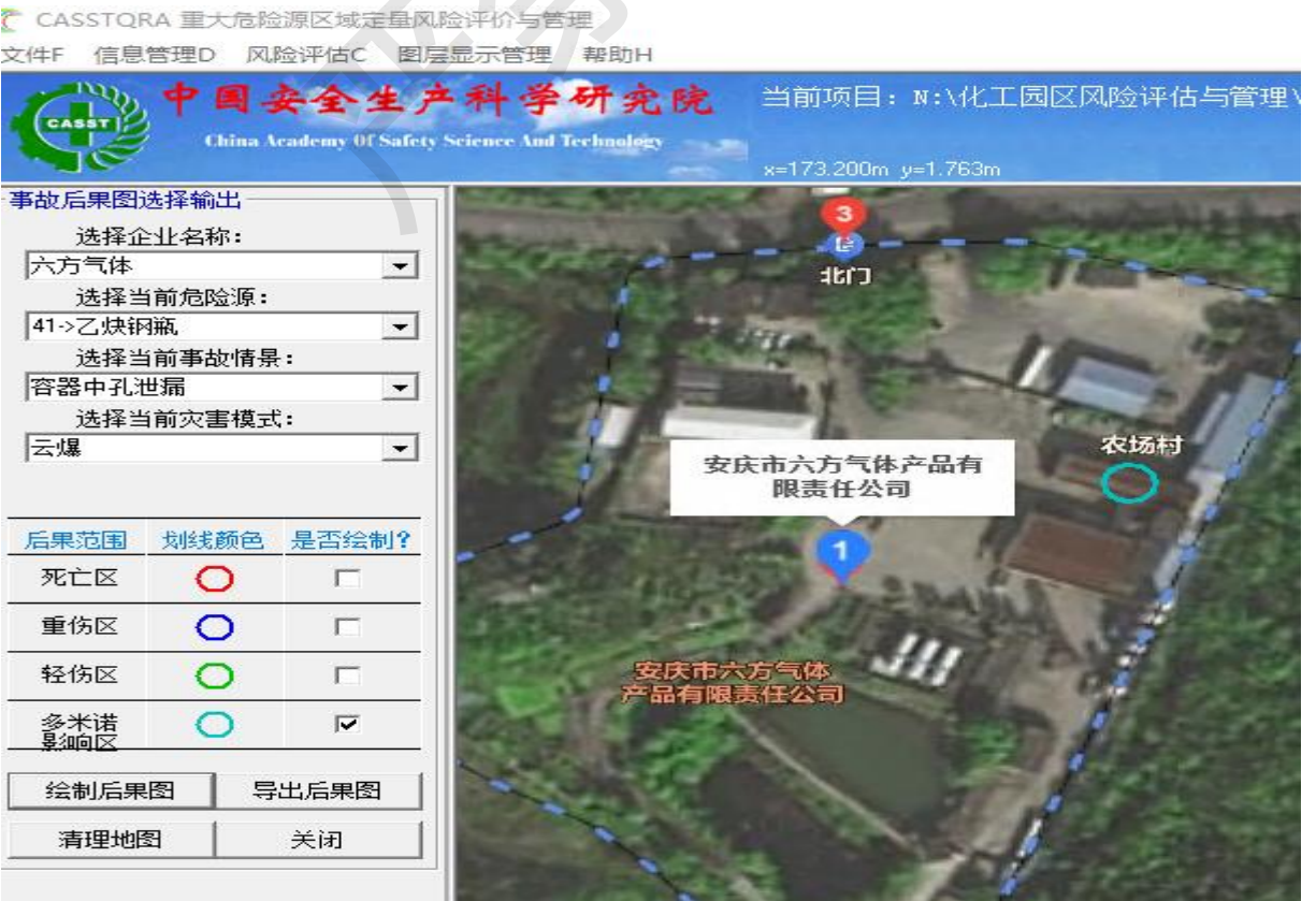
图 4-10 乙炔钢瓶中孔泄漏云爆事故多米诺影响范围模拟图
