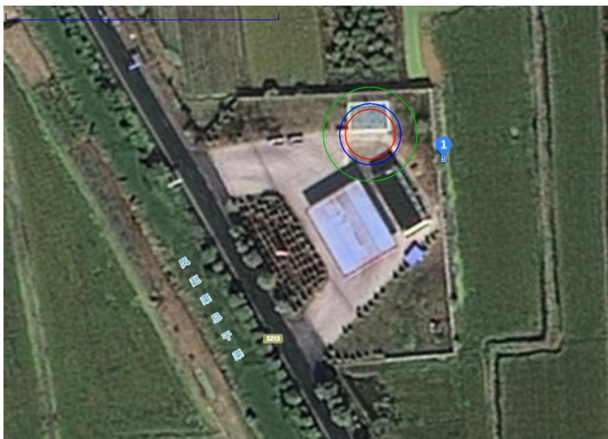
图 5-2 密闭卸油口中孔泄漏、完全破裂池火灾事故后果模拟图
