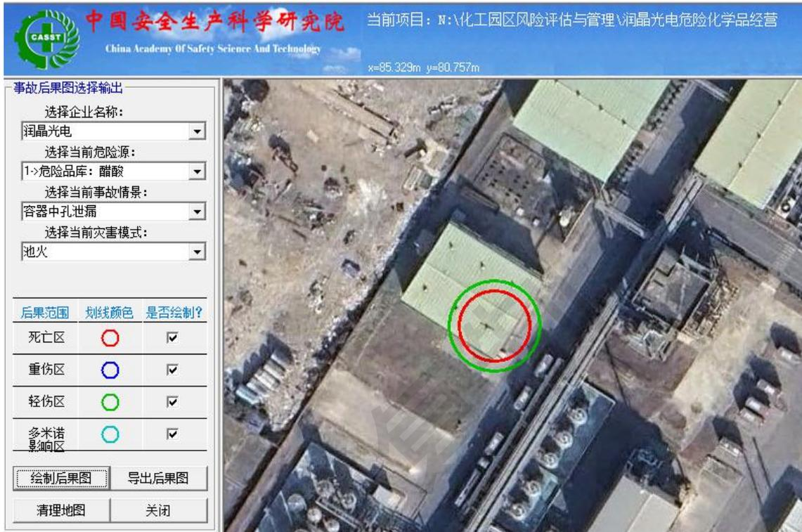
(2) 危险品仓库醋酸容器整体破裂发生池火事故后果模拟图
