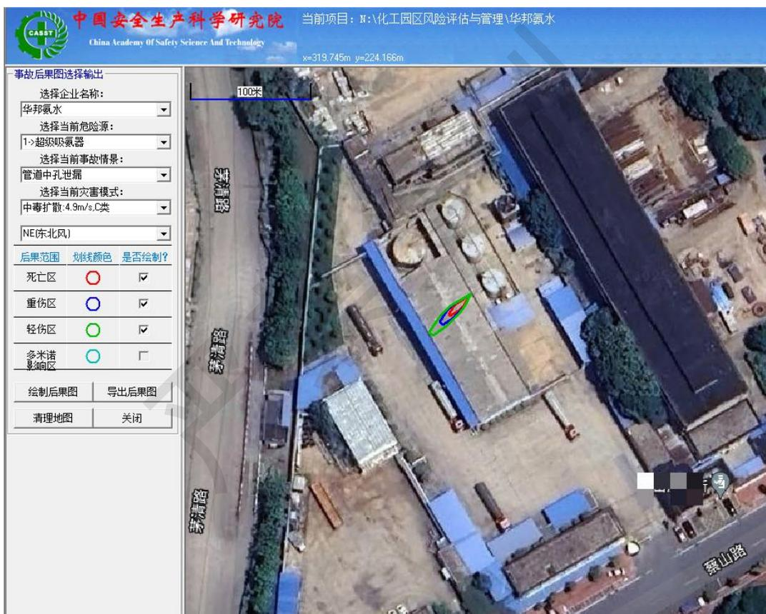
图 4-6 超级吸氨器中孔泄漏中毒扩散事故模拟图
