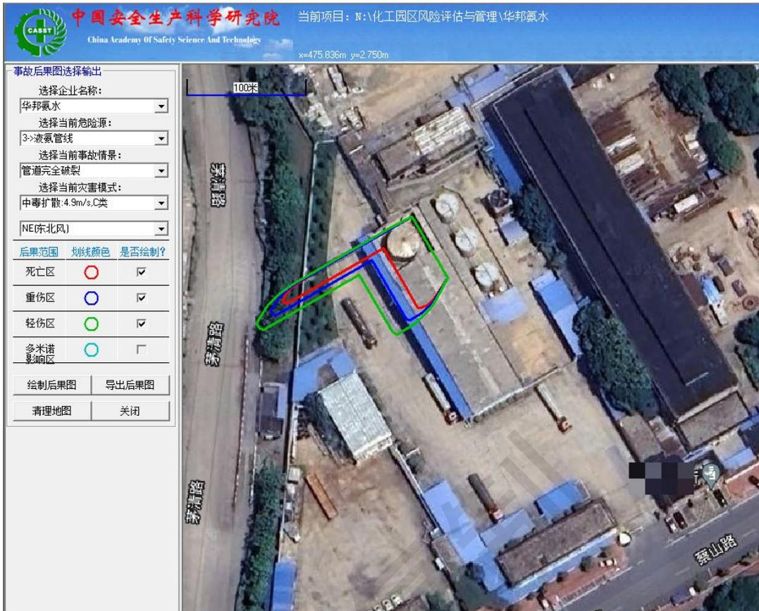
图 4-7 液氨管道完全中毒扩散事故模拟图
